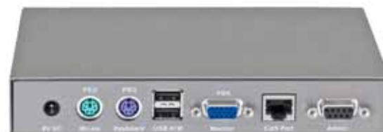
MasterConsoleCAT станция пользователя (вид сзади)
