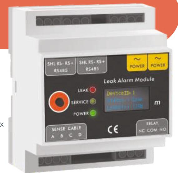
**Модуль позиционирования SYSG5002** может обнаруживать утечку воды, кислот и щелочей, масла и других жидкостей и позволяет подключить чувствительный кабель на расстояние до 1500 метров. При обнаружении протечки место утечки отображается на ЖК-экране и срабатывает реле сигнала тревоги.
