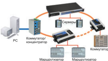
Кольцевая топология Ethernet Turbo Ring предотвращает потерю связи при обрыве соединения.
