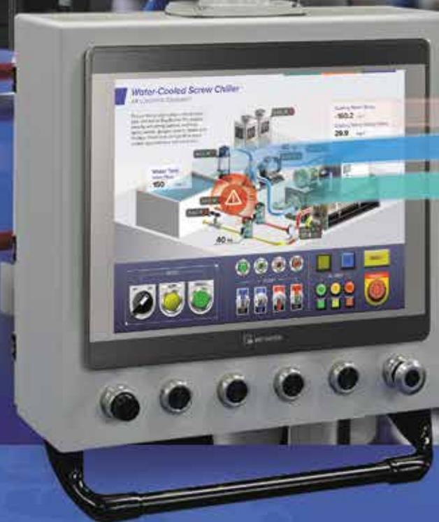
HMI служит не только собирать и обрабатывает данные с устройств, но и играет ключевую роль в IIoT, выполняя функцию шлюза протоколов. Данные устройства, подключенного к HMI, могут публиковаться в системе IIoT.
